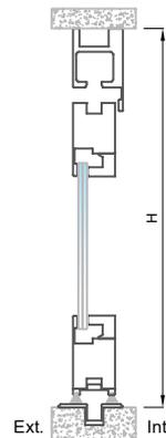
*Nota: En la sección inferior para apertura exterior se puede usar 2 tipos de perfiles FI-4558 o FI-4559, ver cortes de piso (Pág. 13 y 14)*
