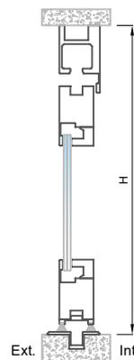
*Nota: En la sección inferior para apertura exterior se puede usar 2 tipos de perfiles FI-4558 o FI-4559, ver cortes de piso (Pág. 13 y 14)*
