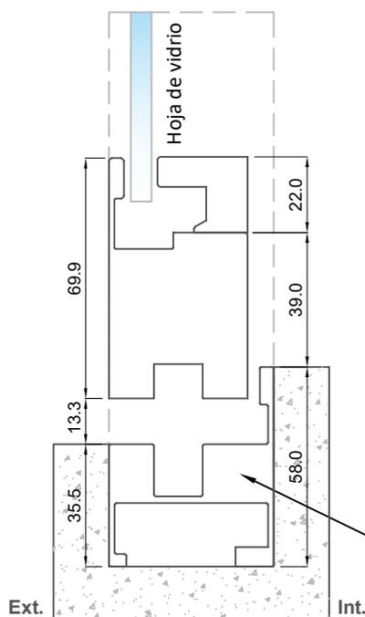
**Sección inferior:** Se puede usar 2 tipos de perfiles FI-4558 o FI-4559, ver cortes de piso (Pág. 13 y 14)
