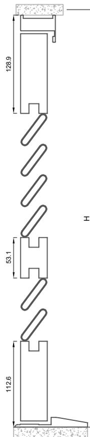
Abatible exterior con estructura de louver con malla
