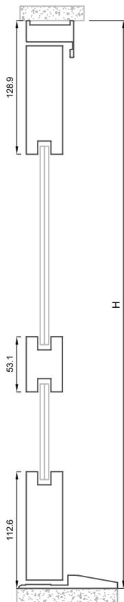
Abatible exterior con estructura de panelado tubular
