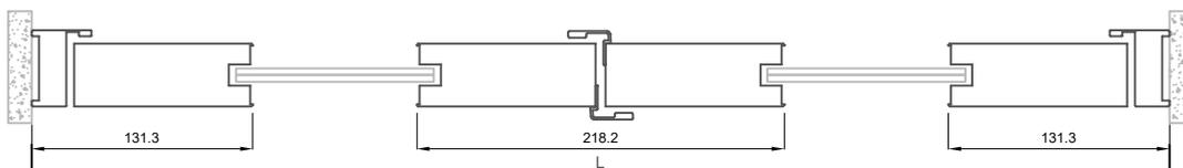
Abatible exterior con estructura de panelado tubular
