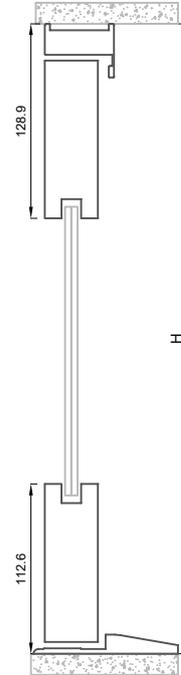
Abatible exterior con estructura de panelado tubular
