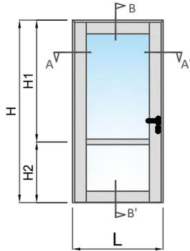
**Estructura: Panelado Tubular**
