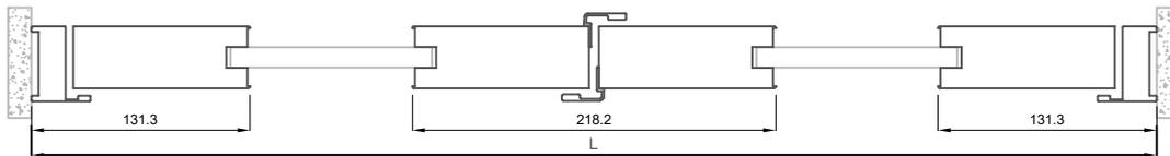
Abatible exterior con estructura de louver sin malla
