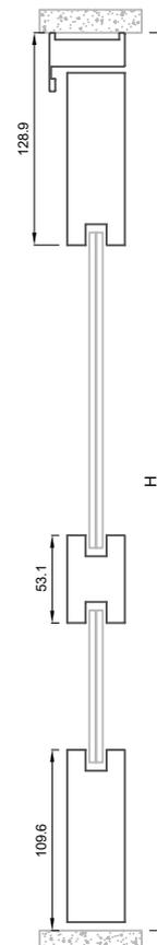
Abatible interior con estructura de panelado tubular
