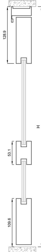
Abatible interior con estructura de panelado tubular
