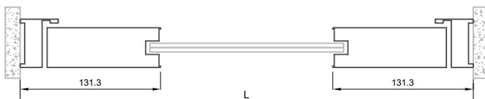
Abatible interior con estructura de panelado tubular
