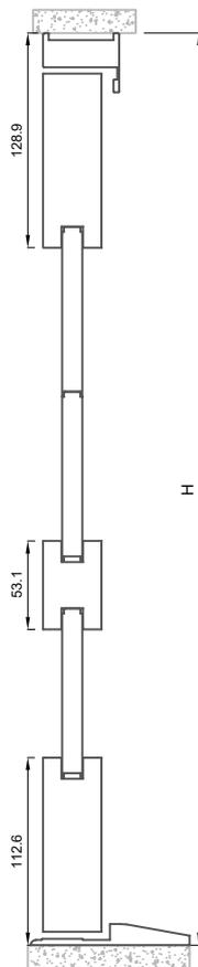
Abatible exterior con estructura de louver sin malla
