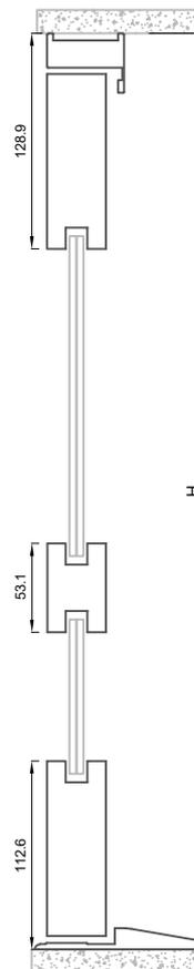
Abatible exterior con estructura de panelado tubular
