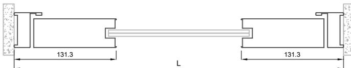
Abatible exterior con estructura de panelado tubular
