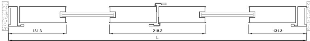
Abatible exterior con estructura de panelado tubular
