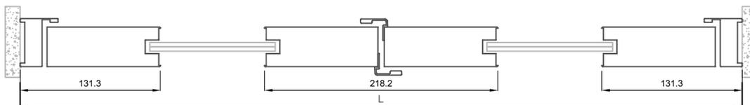
Abatible interior con estructura de panelado tubular
