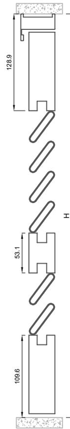
Abatible interior con estructura de louver con malla
