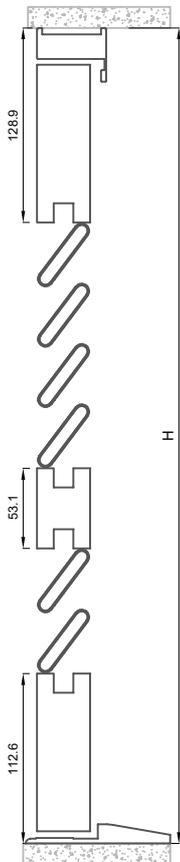
Abatible exterior con estructura de louver con malla
