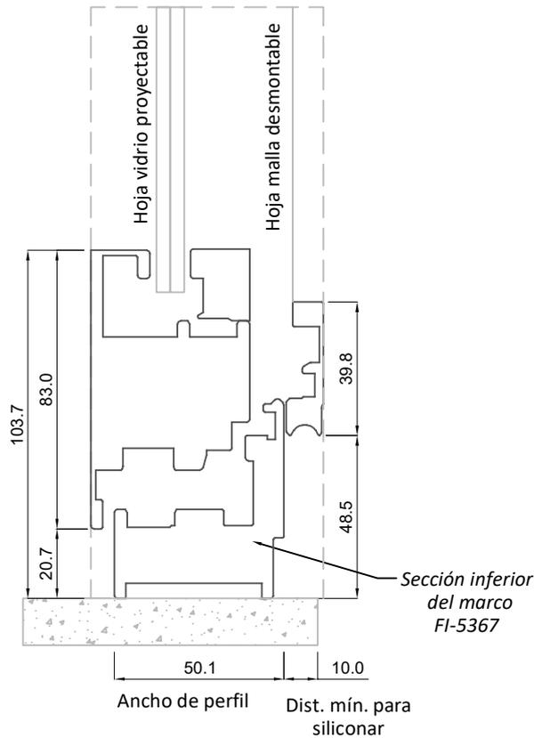
**Detalle de espesor de vidrio**
